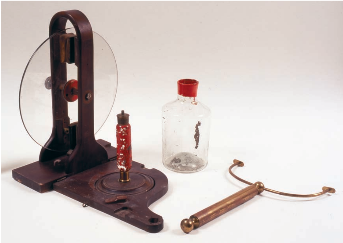
Η ηλεκτροστατική μηχανή με τα εξαρτήματά της. Υλικά : Ξύλο γυαλί χαλκός Διαστάσεις: 0,39 X 0,34μ. Διάμετρος δίσκου: 0,27μ. Η μηχανή συνοδεύεται από μία γυάλινη φιάλη με ηλεκτροσκοπικά φύλλα χρυσού. (Υ:0,20μ. Διάμετρος βάσης: 0,10μ).
