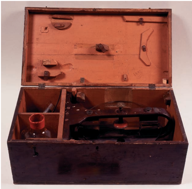
Η ηλεκτροστατική μηχανή μέσα στο ξύλινο κιβώτιο της (0,53 x 0,28 x 0,21) όπως παραδόθηκε από τον δωρητή της, το 1901 στο ΕΙΜ.
